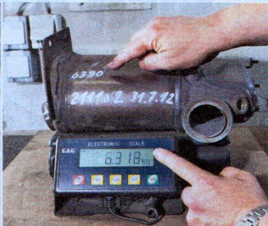
Dokumentiert: Jeder Rußpartikelfilter wird vor und nach der Reinigung gewogen. Dieser Filter wurde immerhin um 62 Gramm Ruß und Asche erleichtert
